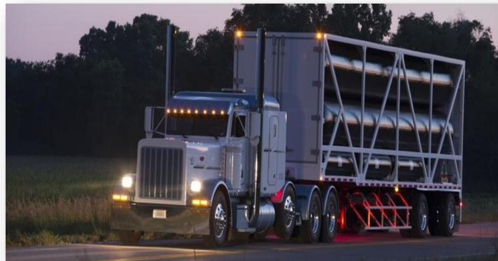
Hexagon Composites har transportløsninger for hydrogen-gass med servicetrykk opp til 250 bar med et vannvolum på inntil 44 000 liter (single operation) eller 88 000 liter (tandem operation). Kilde: Hexagon Composites.
